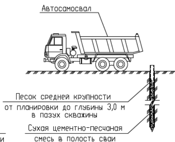
Рисунок 6 - Типовая технологическая схема погружения свай
